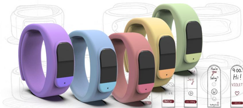
考虑到**大批量生产**问题，硬件造型采用简洁化设计和圆滑处理，同时采用较为鲜艳的颜色，使儿童对其有**亲和感**。在最终设计中，圆角矩形的玻璃触摸屏及麦克风孔的搭配设计被选用，采用矩形作为基本形状，便于界面设计元素的排列和识读。
